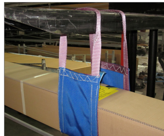
4. Mit Hub-Hebegerät oder Kran das Paket zum Zielort befördern
